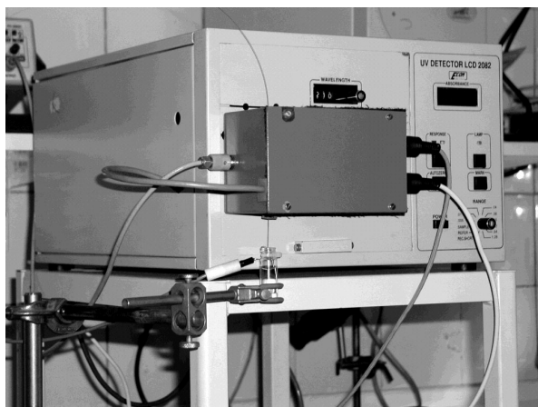
Obr. 3. Umístění kombinovaného detektoru na čelním panelu UV detektoru LCD 2082 (Ecom, ČR); separační kapilára vstupuje do detektoru shora, pod detektorem je koncová elektroforetická nádobka. Na levé straně detektoru jsou konektory BNC pro přívod střídavého napětí z funkčního generátoru k vodivostní části a kabel spojující velkoplošnou diodu s elektronikou UV detektoru. Konektory vpravo – viz obr. 2
